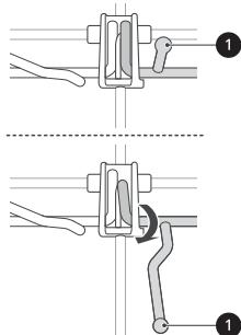
Stojany na sklenice poskytují podporu pro skleničky s dlouhou stopkou.
