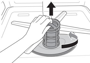
**3** Filtry vyčistěte měkkým kartáčkem pod tekoucí vodou. Před opětovnou instalací filtrů filtrovou znova smontujte.
