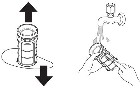
**4** Chcete-li vyměnit smontované filtry, umístěte ostřikovací rameno tak, aby širší svar směroval dopředu. Filtry vložte zpět do držáku filtrů a zajistěte je otočením vnitřního filtru ve směru hodinových ručiček, dokud nezapadne na své místo.
